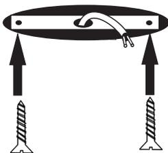
Fixe no teto a chapa de fixação da canopla de acabamento e passe os fios no furo central.
