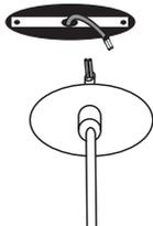
Com a rede elétrica desligada, conecte os fios e isole com fita isolante antichamas.
